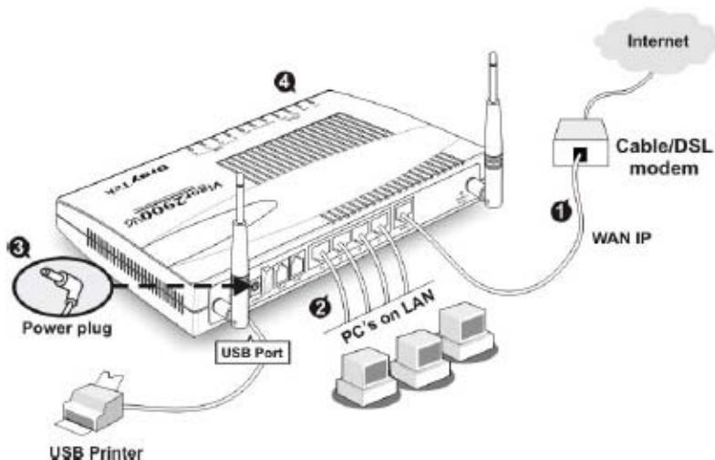
Cihaz ile fiziki bağlantınızın çalışıp çalışmadığını kontrol etmek için bilgisayarınızdan cihazı ping ediniz.
