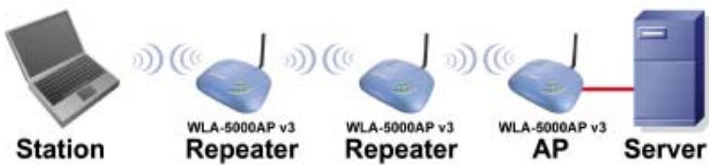
Bu modda bir cihaz AP modunda bulunurken diğer cihazları bu cihazın yapmış olduğu yayını tekrarlayan cihaz olarak kullanabilirsiniz.
