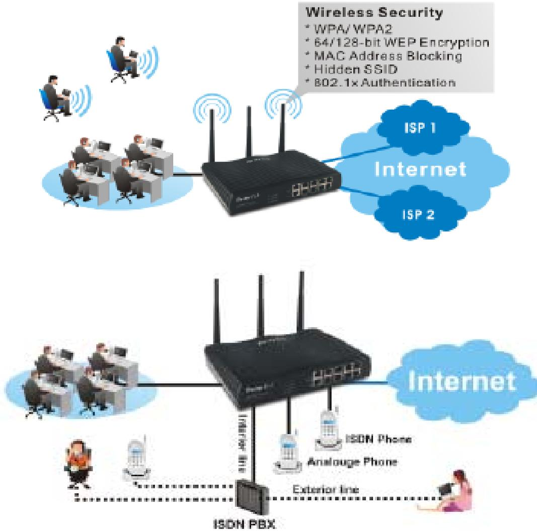
V2930V ile noktadan noktaya VOIP bağlantısı kurabileceğiniz gibi bir ITSP (Telefon Servis Sağlayıcısı) vasıtası ile de VOIP bağlantısı kurabilirsiniz.
